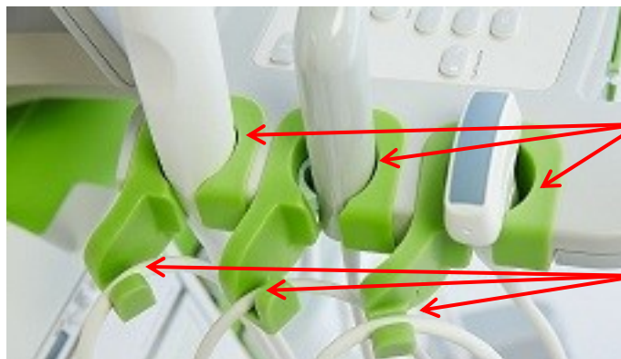
Rys. 36: Uchwyty na przetwornik/ żel i prowadnice kabla
