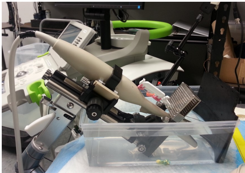
Rys. 41: Przetwornik i stepper przekroczeniowy w kąpielii wodnej
