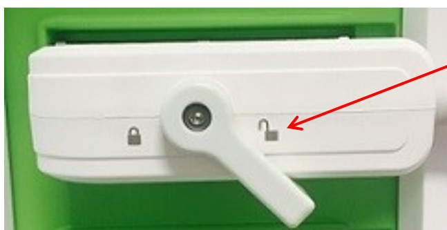
Rys. 29: Odblokowane pokrętło blokujące złącza przetwornika
