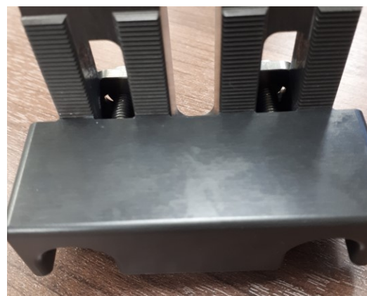
Rys. 38: Wyśrodkowany uchwyt na siatkę szablonową
