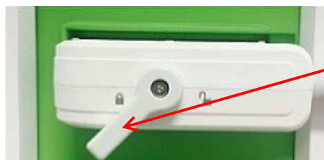
Rys. 28: Orientacja złącza przetwornika
